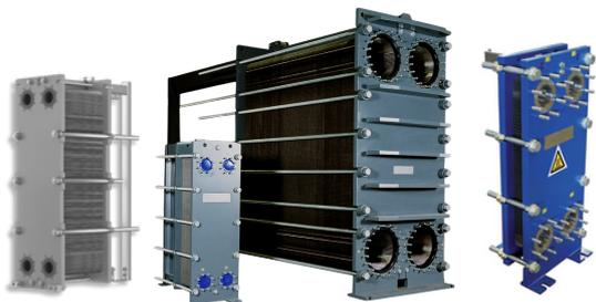
Les échangeurs à plaques et joints démontables sont composés d'un ensemble de plaques métalliques corruguées/cannelées par estampage à froid. La forme particulière de nos plaques leur confère un haut niveau de turbulence des fluides et un échange thermique optimal.
